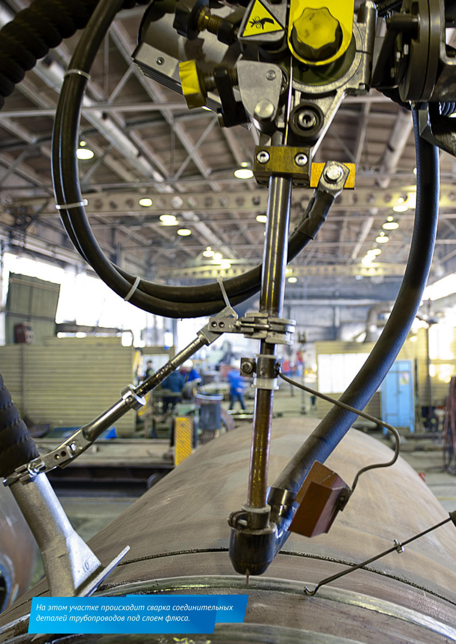
На этом участке происходит сварка соединительных деталей трубопроводов под слоем флюса.
